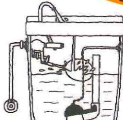
●給水で水位とともに浮き玉も上がり、ボールタップの弁が閉じ、給水が停止します。
